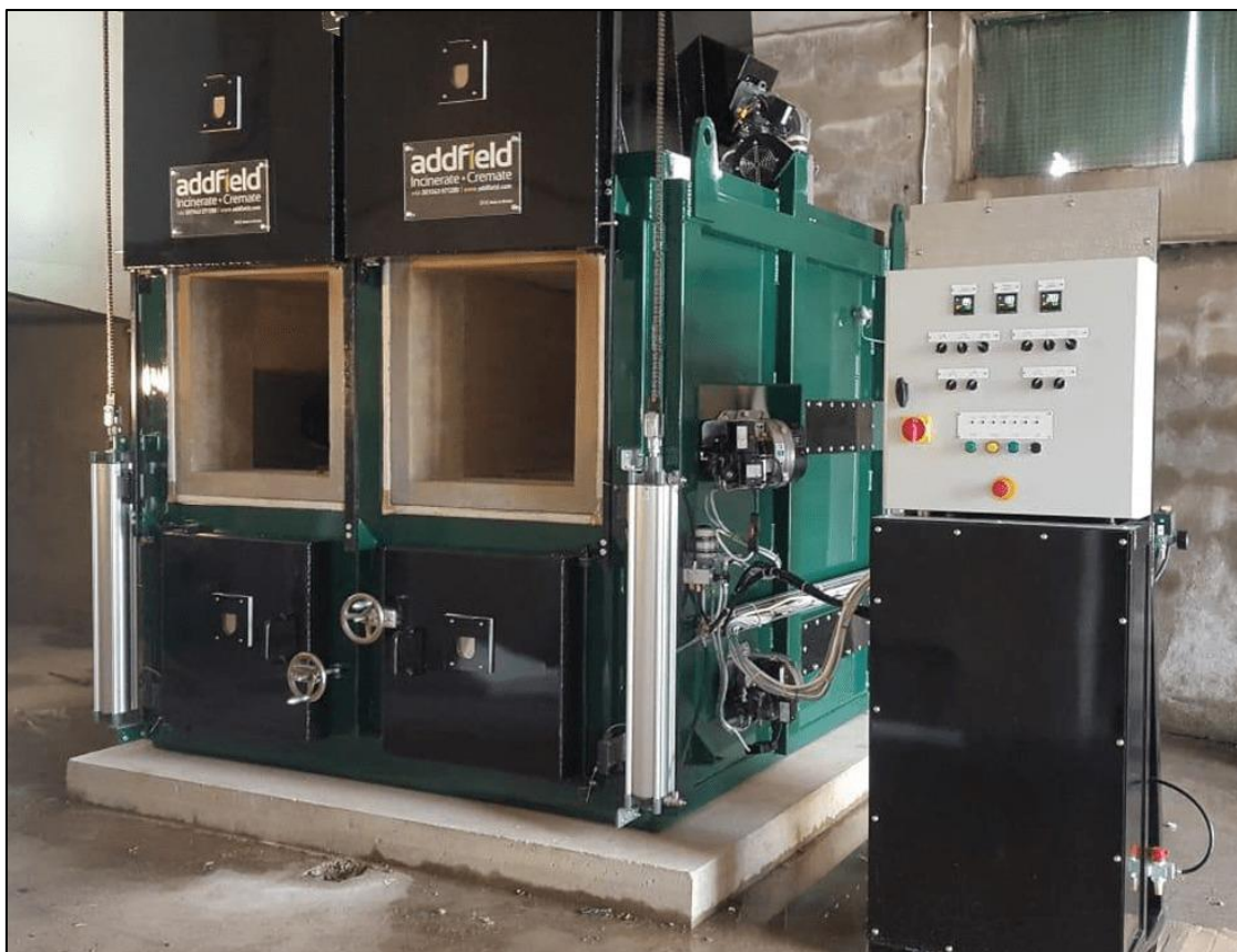
Figur 12. Krematorieugn A50-IC-2. Bild från tillverkaren Addfield, 2025-09-17. Samtliga luckor i installerad modell i sökt verksamhet öppnas dock från sidan.
