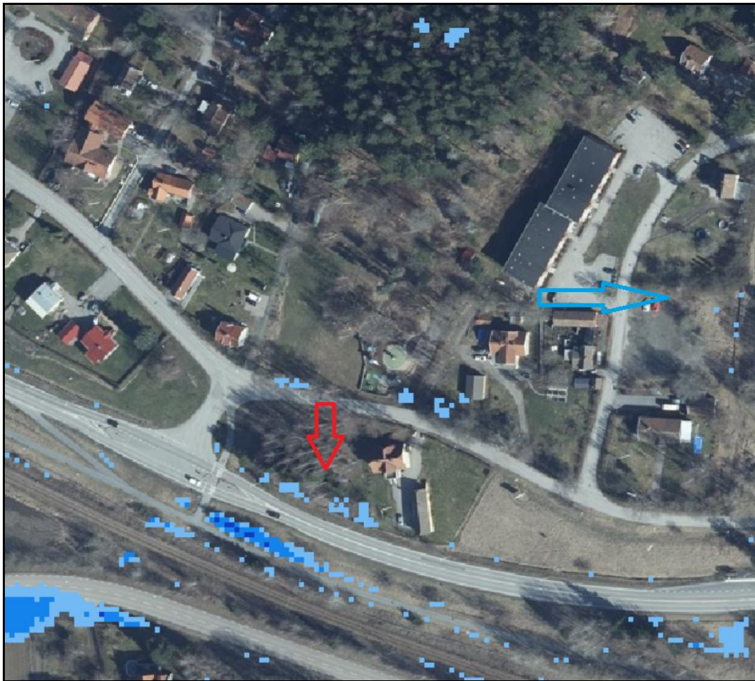
Figur 10 Lågpunktskartering från WebGIS Uppsala län. Röd pil visar mindre lämplig riktning för yttlig avledning av dagvatten, blå pil visar föreslagen riktning.
