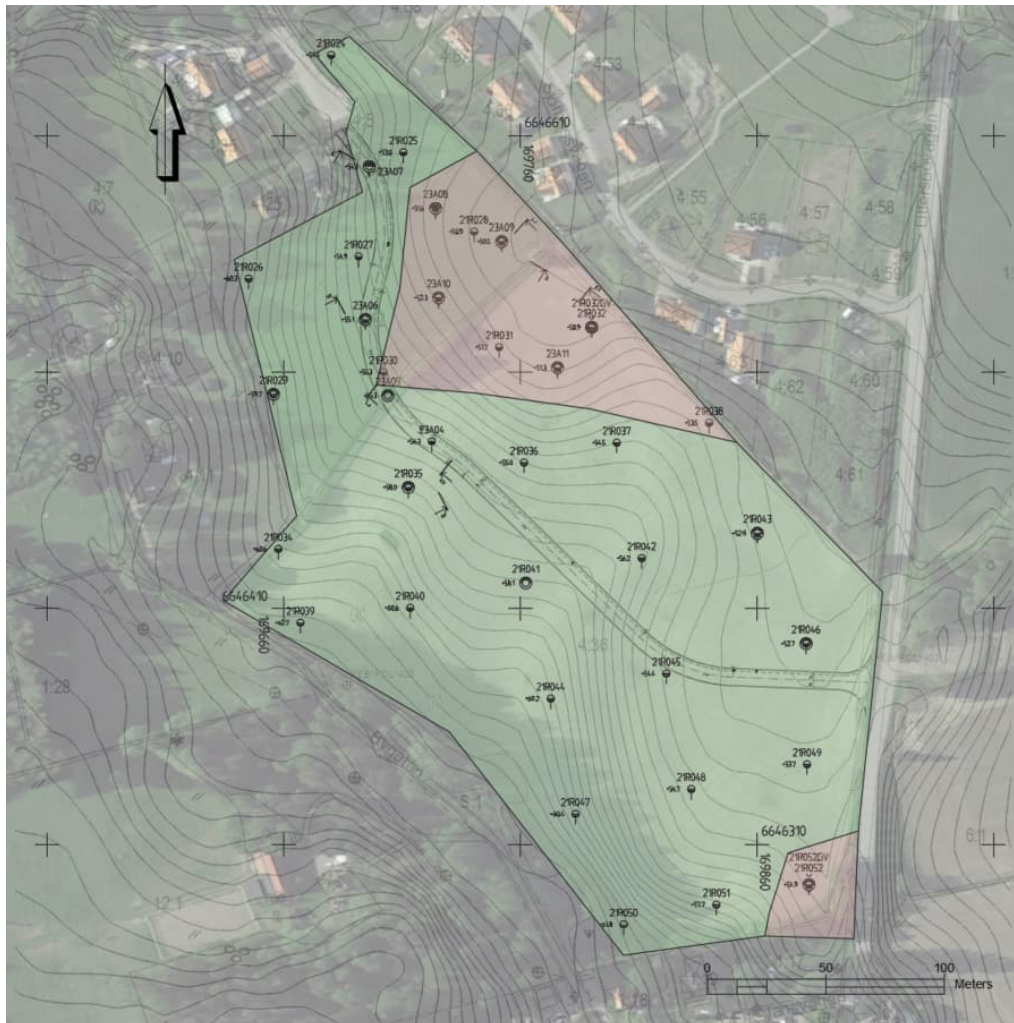
Figur 5.1. Lerdjup och markens byggharhet Gröna området är med god byggharhet och röda är med något sämre. Indelning av området baserat på tidigare och nu utförda undersökningar.
